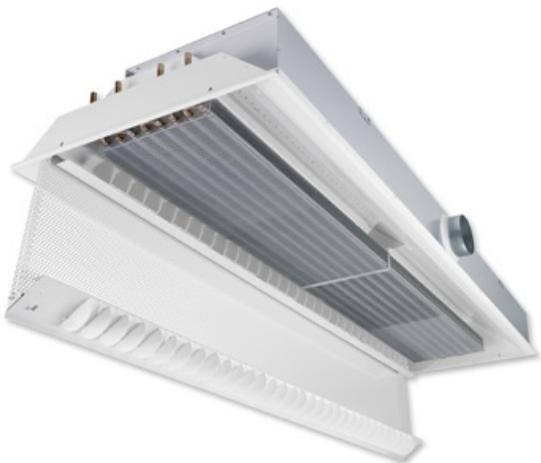
*Die Serie DID642 in den Abmessungen 900 - 3.000 x 600 x 170 mm (LxBxH) ist ausgelegt für eine Kühlleistung bis 2.600 W bzw. Heizleistung bis zu 3.500 W und ist für Volumenströme von 8 - 85 l/s bzw. 30 - 300 m³/h einsetzbar.*
