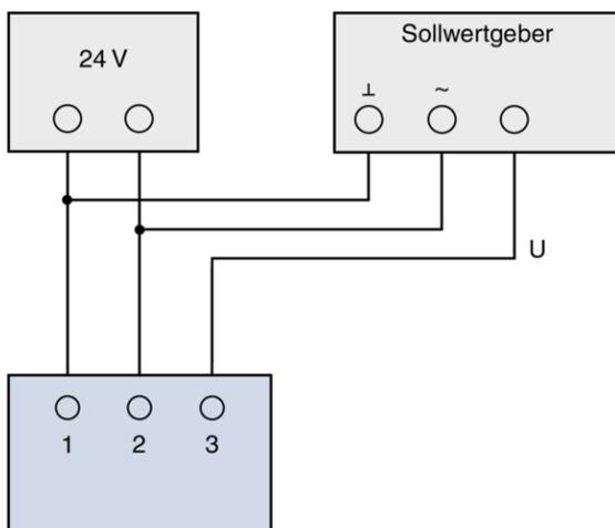
U Spannungssignal 0 – 10 V DC oder 2 – 10 V DC
