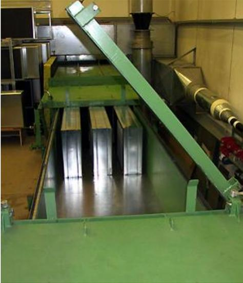
Die Prüfstrecke, eine doppelwandige, schallgedämmte und luftdichte Kanalstrecke ist an den Hallraum angeschlossen. Durch den in der Kanalbreite variablen Teil sind Schalldämpferelemente (Kulissen) unterschiedlicher Breite und Abstand prüfbar. Gemessen werden Schalldämpfereigenschaften wie Einfügungsdämpfung, Strömungsgeräusch und Druckverlust.
