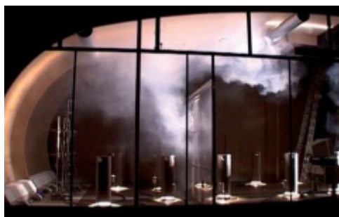
Strömungstests: 1:1 Aufbau im TROX Forschungs- und Entwicklungslabors
