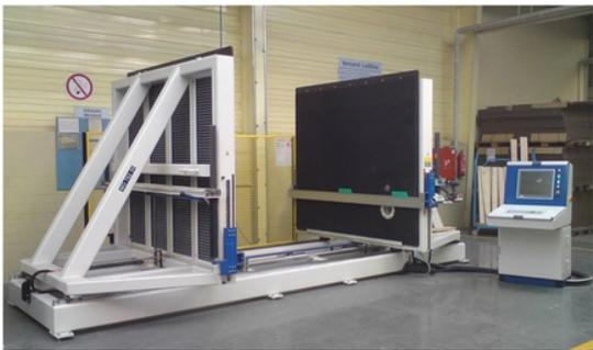
Der Universal-Leckage-Prüfstand (ULPS) im Werk in Anholt dient zur Prüfung der Klappen- und Gehäuseleckage von Regelgeräten nach DIN EN 1751 an mehreren Betriebspunkten. Dabei sind Prüfungen mit einem Leckage-Messbereich von 0,008 l/s - 300 l/s und einem Prüfdruck von 100 Pa- 2000 Pa möglich.
