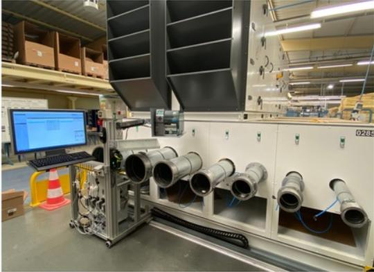
Die VVS-Prüfstände dienen der Parametrierung, Prüfung und Justage von variablen und konstanten Volumenstromreglern mit verschiedensten Anbaugruppen sowie Volumenstrommess- und -einrichtungen. Dabei erfolgt eine werkseitige Einstellung kundenspezifischer Betriebsdaten sowie eine individuelle Geräteprüfung unter Luft. Dieser Prozess dient der Qualitätskontrolle jedes einzelnen Regelgerätes zum Abschluss des Fertigungsprozesses.
