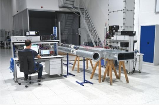
Im großen Testsaal des ICKA werden an mobilen Messplätzen lufttechnische Prüfungen im Bereich Regeltechnik durchgeführt. Dabei deckt der Bereich Regeltechnik sowohl Tests an variablen und konstanten Volumenstromreglern mit unterschiedlichsten Anbaugruppen als auch Tests an reinen Volumenstrommesseinheiten ab.
