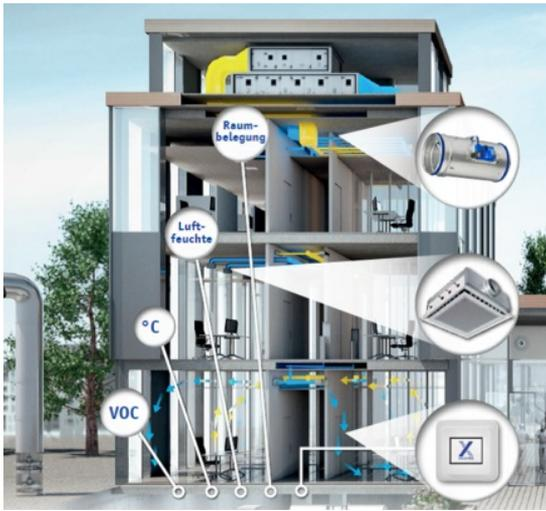
Abbildung 1: Schematische Darstellung einer Einzelraumregelung
