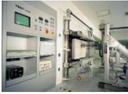
Test rig EN 1822-4
