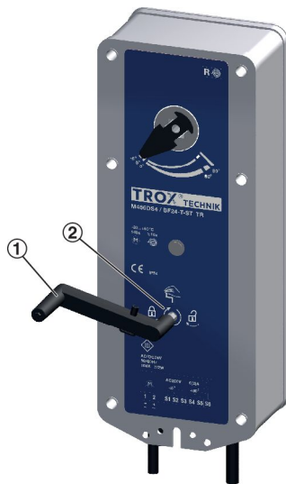
Abb. 8: Funktionsprüfung (ohne angeschlossene Versorgungsspannung)
