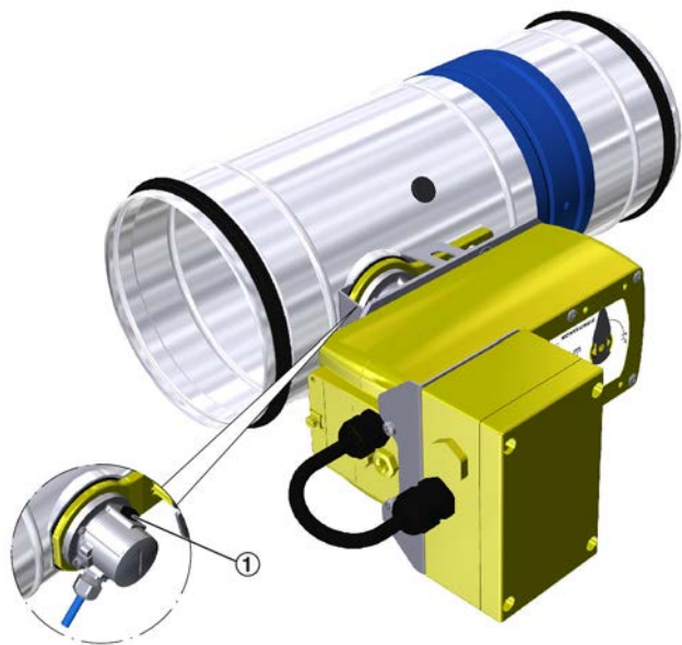
Abb. 6: Funktionsprüfung (FKRS-EU mit ExMax-Antrieb in AUF-Stellung dargestellt)
