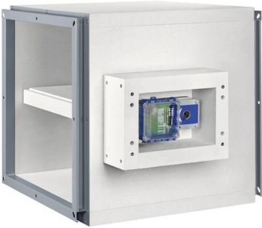
TROX Entrauchungsklappen EK-EU, CE-zertifiziert, gem. BauPVO, sind in der Lage, noch nach 25 Min. bei erhöhten Temperaturen (ca. 800 °C) von der geschlossenen in die geöffnete Stellung und umgekehrt zu fahren.
