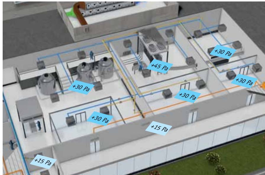
Lufttechnische Abgrenzung sensibler Bereiche durch eine präzise Druckregelung.
