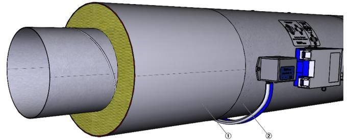
Abb. 16: Regelgerät mit Dämmung z.B. TVR-D
