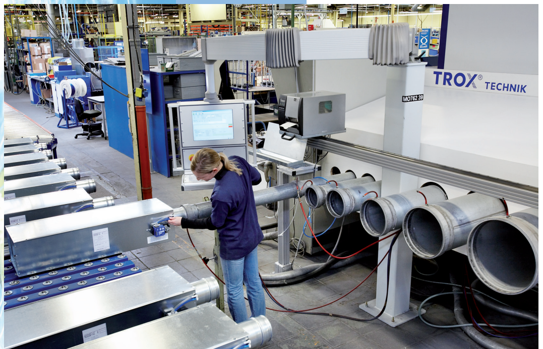
Herstellung und Justage von Volumenstrom-Regelgeräten
