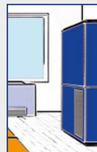
Freistehendes Lüftungsgerät reduziert bauliche Maßnahmen
