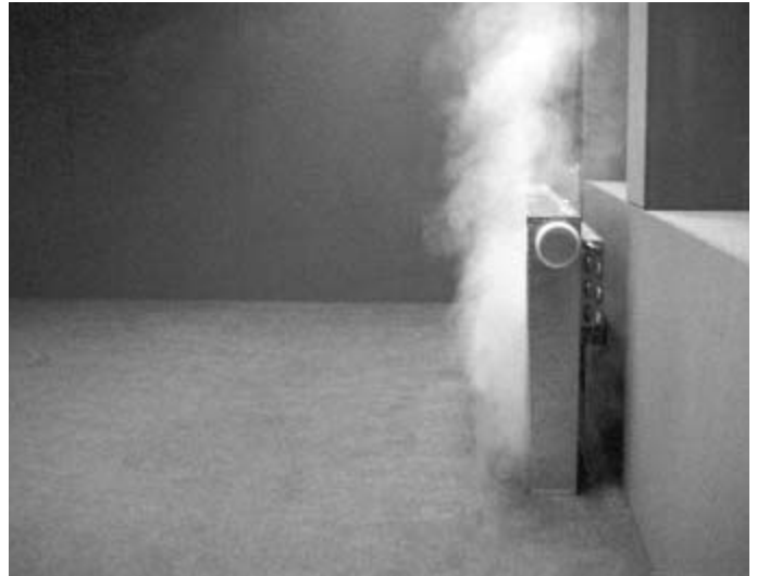
Strömungsbild: Heizbetrieb mit Primärluft
