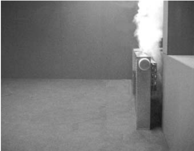
Strömungsbild: Heizbetrieb ohne Primärluft
