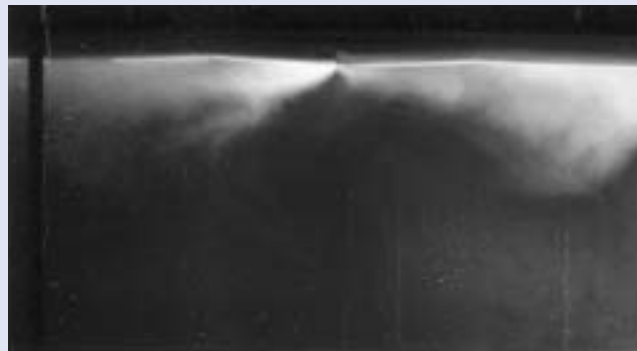
Bild 4: VSD35-1-Varyset, \dot{V} = 11 \text{ l/s} ; \Delta t = - 8 \text{ K}
