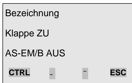
Bild 6.8.2: Anzeige der Einzelsteuerung einer nicht angesteuerten Brandschutzklappe
