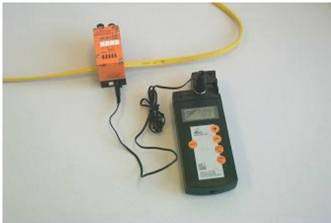
Bild 7.3.1: Adressieren eines AS-i Moduls per Adressierstecker
