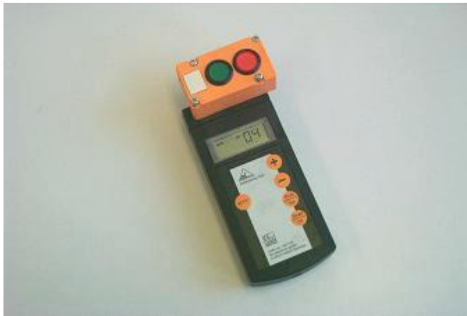
Bild 7.3.2 Adressieren eines AS-i Moduloberteiles durch direktes Aufstecken
