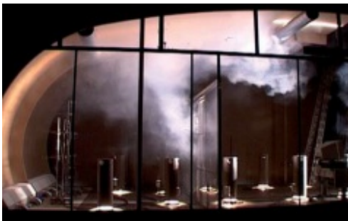
Strömungstests: 1:1 Aufbau im TROX Forschungs- und Entwicklungslabors
