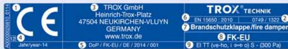
Abb. 3: Geforderte Angaben bei der CE-Kennzeichnung am Beispiel eines Typenschildes für eine Brandschutzklappe
